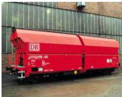
Moderner Güterwagen kann 100 t laden und ist ca. 20 m lang
