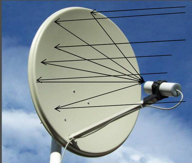
Strahlen, die parallel zur optischen Achse einfallen, verlaufen nach der Reflexion immer durch den Brennpunkt  $F$
