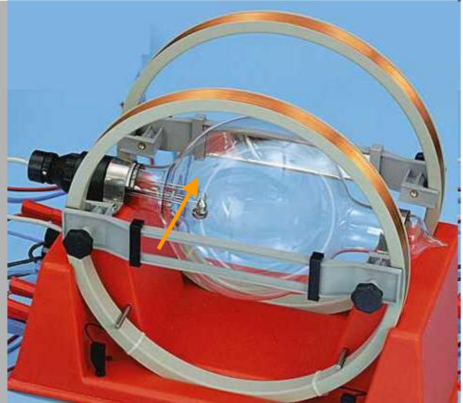
$$B = \mu_0 \frac{8 \cdot I \cdot N_{\text{Spule}}}{\sqrt{125} \cdot r_{\text{Spule}}}$$
